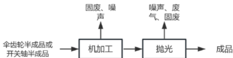
图 2-2 项目伞齿轮、开关轴生产工艺流程及产污环节示意图
