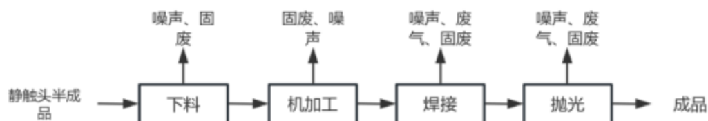
图 2-3 项目静触头生产工艺流程及产污环节示意图
