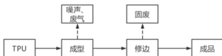
图 2-2 现有项目 TPU 鞋材生产工艺流程及产污节点示意图
